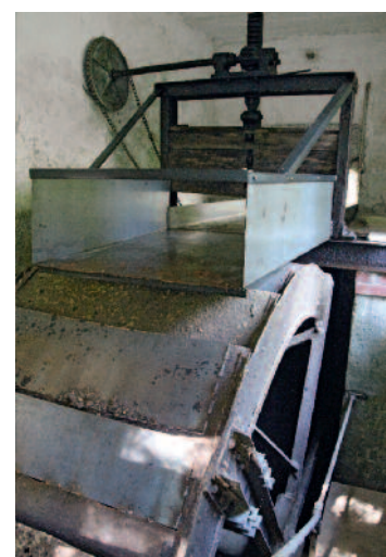
2 Liegende, doppelwirkende Kolbenpumpe mit Ledermanschette und Windkessel.
